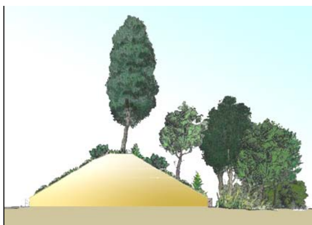
Figura 29 - Esempio di intervento per la mitigazione dell'impatto acustico ed inserimento visivo in ambito naturale
